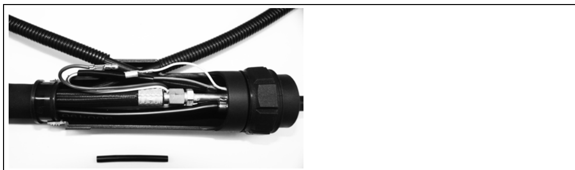
Fig. 16 Démontez un câble de bouton
