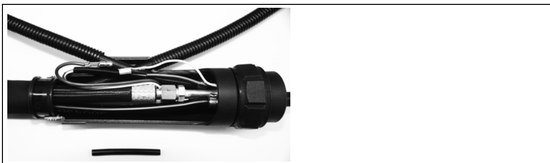
Afb. 16 Een stuurleiding demonteren
